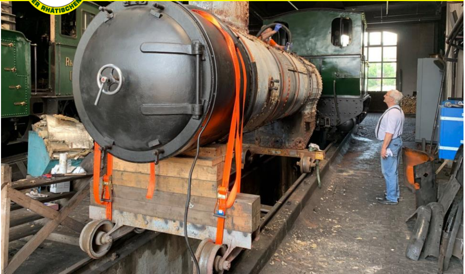
Der Kessel der „RHÆTIA“ wurde frei gelegt (Bild: Projektgruppe „RHÆTIA“)
